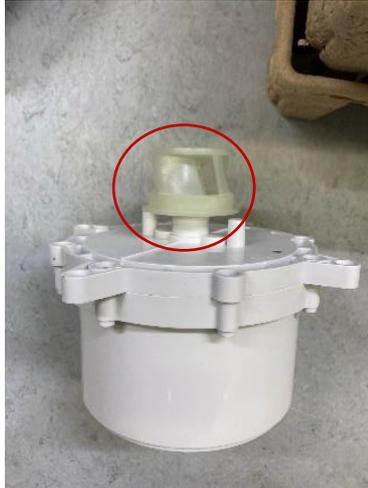
Prüfen Sie das Pumpenrad, reinigen Sie es gegebenenfalls und montieren Sie es danach wieder mit den vier Schrauben am Oberteil. Achten Sie bei der Montage auf ein geringes Drehmoment.
