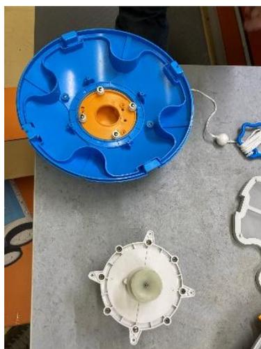
Haare oder ähnliches im Pumpenrad bzw. auf der Welle können die Pumpleistung stark reduzieren, wodurch der Roboter wenig bis nichts mehr reinigen kann oder auch stehen bleiben kann bzw. nicht mehr umdreht.
