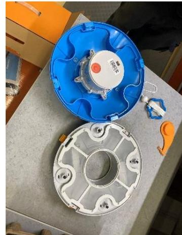
Danach können Sie die Motoreinheit demontieren; dazu lösen Sie die vier Verbindungsschrauben. Sie benötigen hierzu einen passenden Kreuzschraubendreher oder Akkuschrauber mit passendem Bit.
